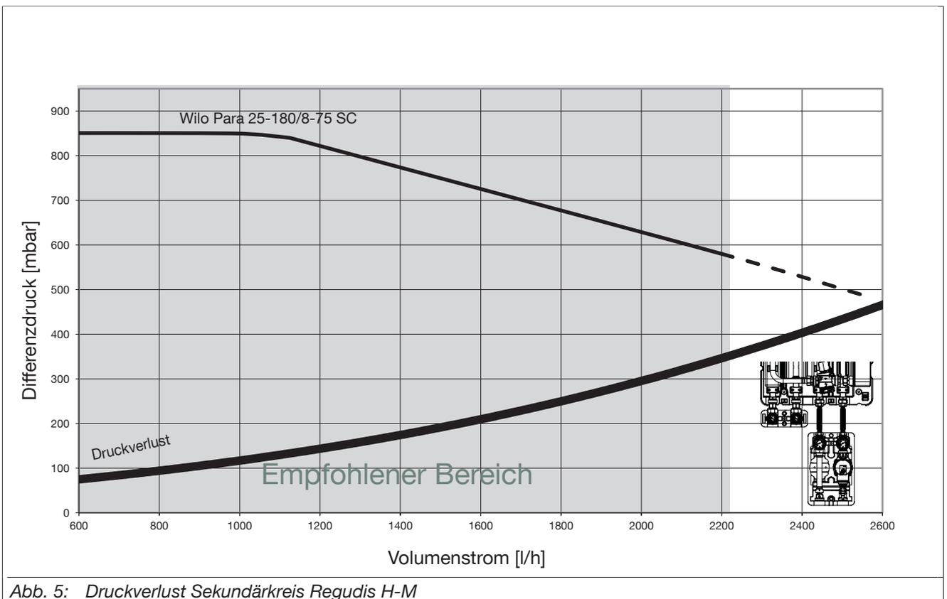
Abb. 5: Druckverlust Sekundärkreis Regudis H-M
