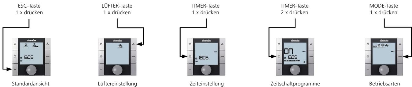
**i** Wenn länger als 3 Sekunden keine Bedienung über den Navigator oder die Funktionstasten erfolgt, wird die letzte Wertänderung abgespeichert und die Standardansicht aufgerufen.
