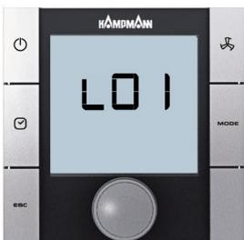
Der KaController bietet die Möglichkeit, die Funktion der angeschlossenen externen Geräte unabhängig von der Software-Applikation zu prüfen. Die Funktion einzelner Baugruppen, wie z.B. des EC-Ventilators, kann über Eingaben am KaController direkt aktiviert und überprüft werden.
