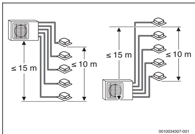
Bild 16 Maximale Höhen
