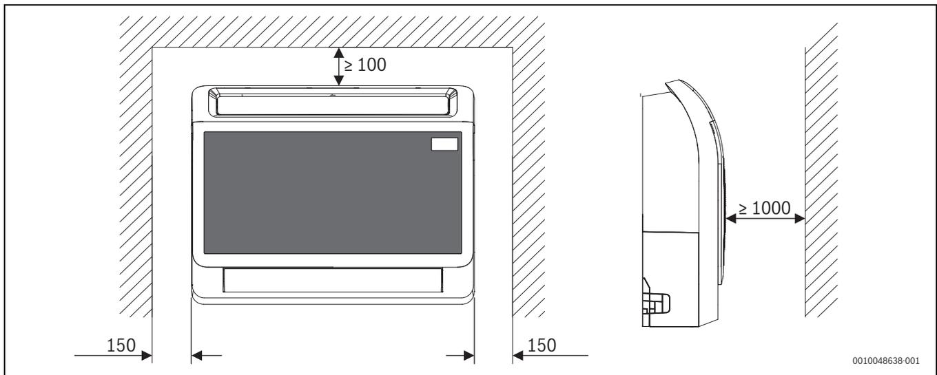
*Bild 5 Mindestabstände Inneneinheit (Konsole) (Maße in mm)*
