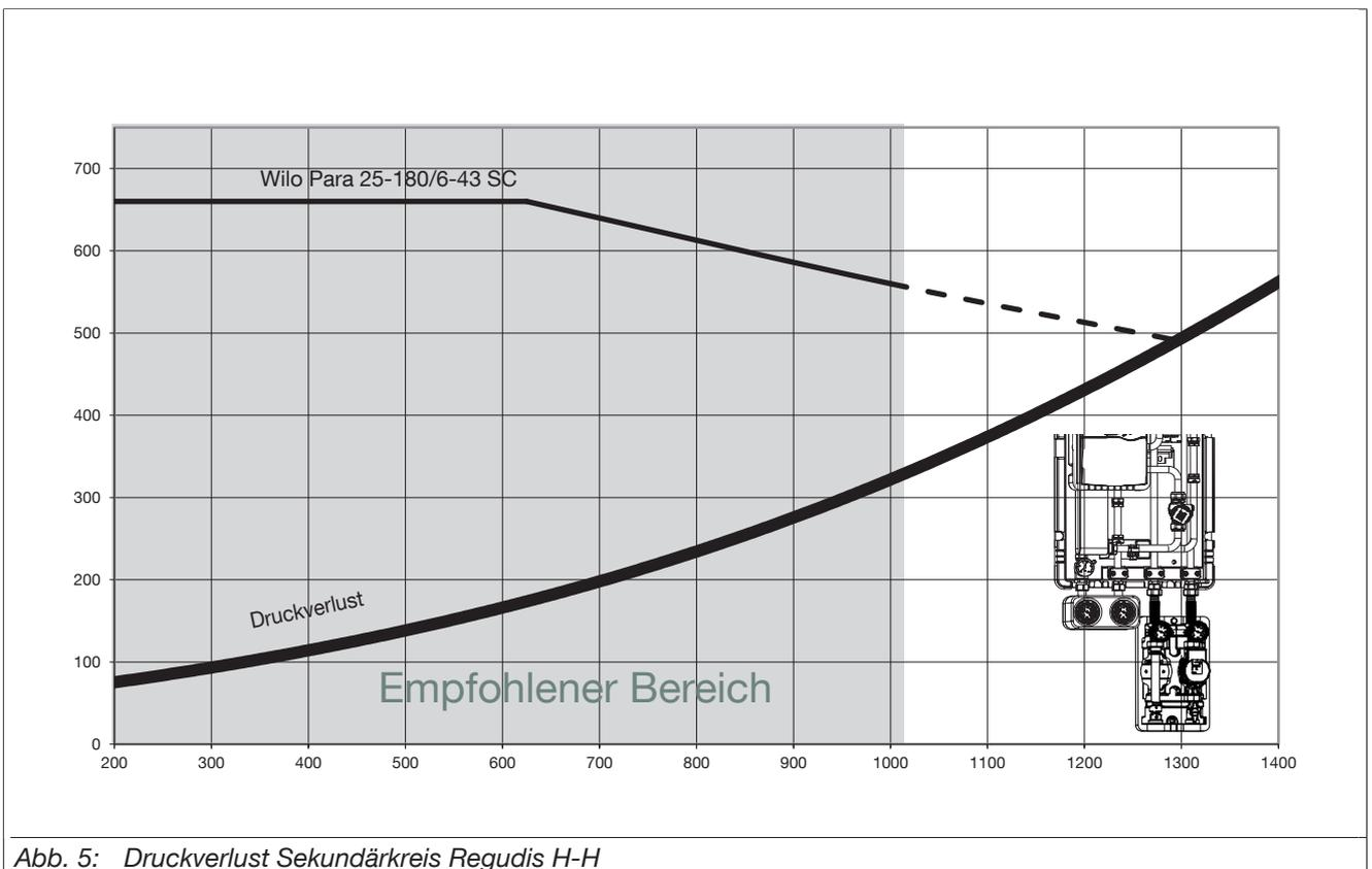
Abb. 5: Druckverlust Sekundärkreis Regudis H-H
