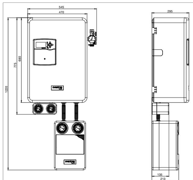
Abb. 3: Abmessungen in mm
