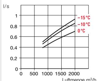
⑤ Wasserdruckverlust bei 70/50 °C<sup>1)</sup>
