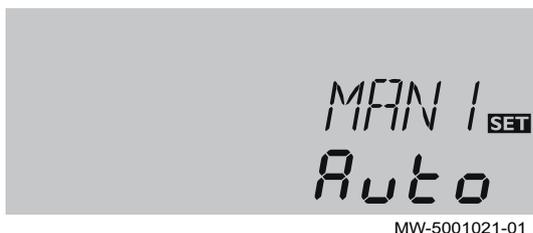
Im manuellen Betrieb kann ein Relais manuell aktiviert werden, um die Pumpen und Ventile für Wartungs- und Kontrollarbeiten zu betreiben.
