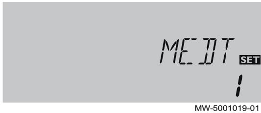
Mit dem Parameter **MEDT** kann der Typ des verwendeten Frostschutzmittels eingestellt werden.
