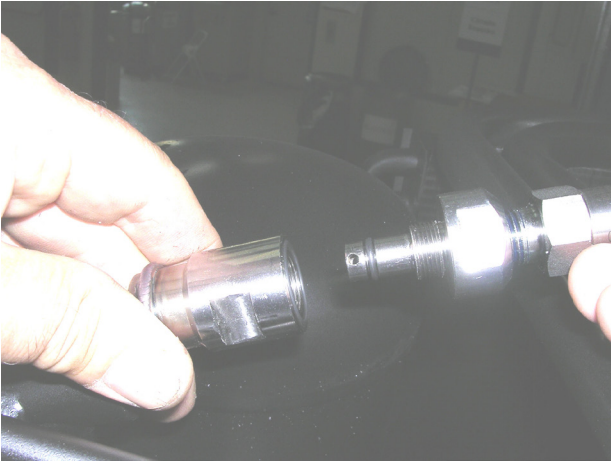
Abbildung 9.6 Entfernen des beweglichen Teils des Sicherheitsventils - Entfernen des Sicherheitsventils
