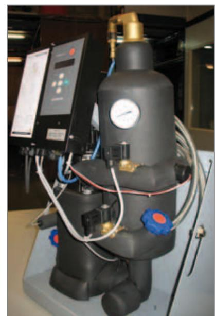
Für Kühlzwecke sind für die Modelle S6, S10 und S16 isolierte Spezialversionen verfügbar.
