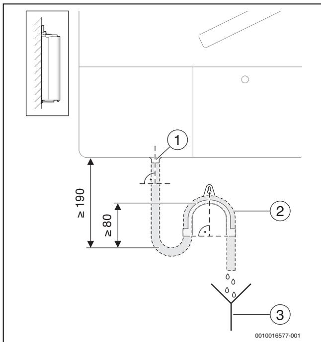
Bild 32 Kondensatableitung bei Wandinstallation mit CKS 100
