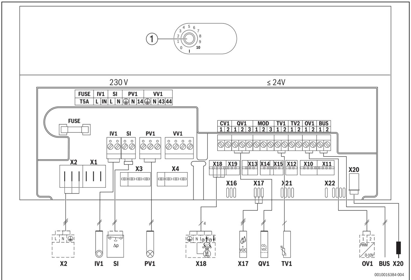
Bild 65 Bauseitige elektrische Anschlüsse auf der Leiterplatte
