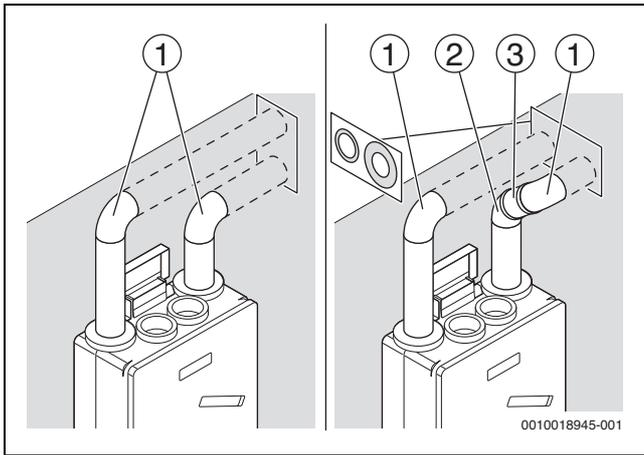
Bild 44 Anschlussdetails zu Bild 40 bis 42: Rohrleitung Außen-/Fortluftleitung
