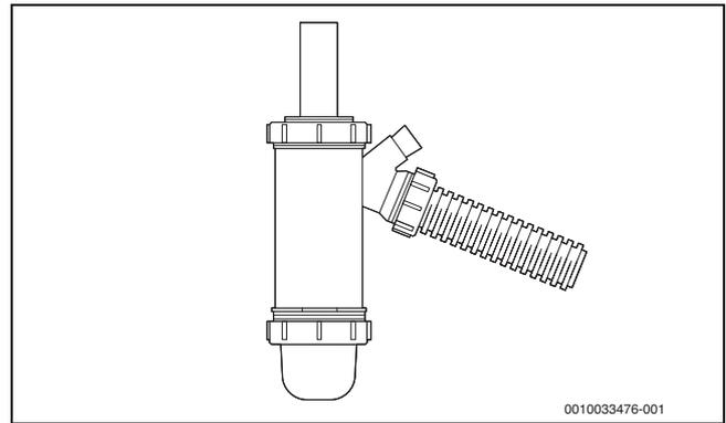
Bild 33 Kugelsiphon-Anschluss-Set
