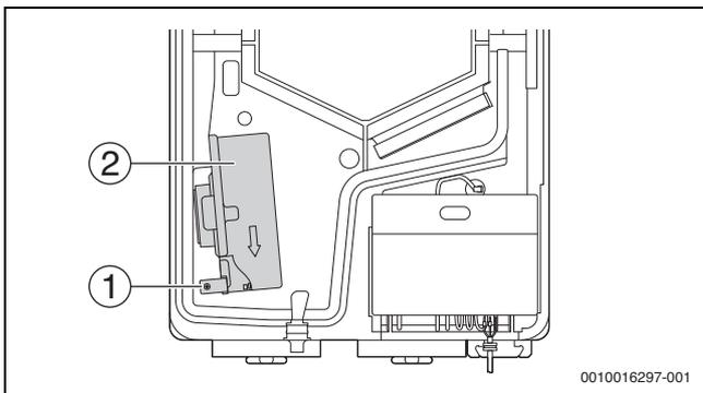
Bild 21 Abluftgebläse in Position für Deckeninstallation
