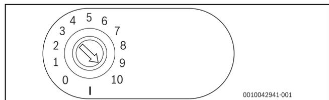
Bild 64 Kodierschalter auf Position 10 = autarker Betrieb
