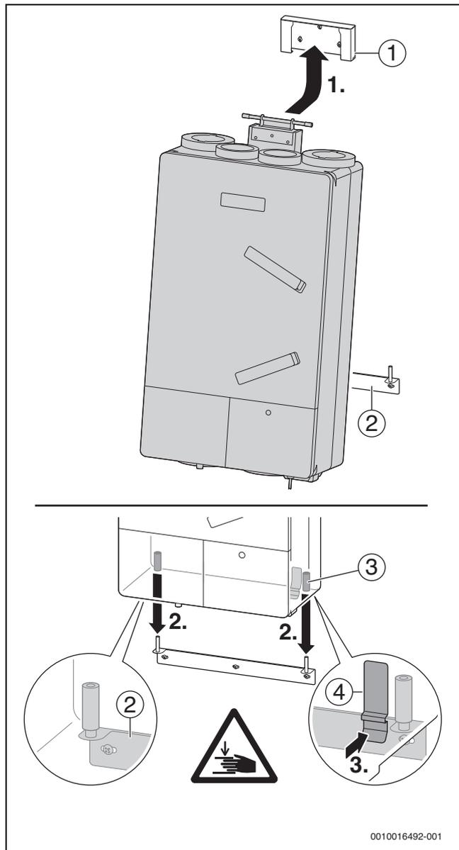
Bild 28 Gerät montieren
