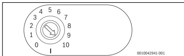
Bild 57 Kodierschalter auf Position 10 = autarker Betrieb
