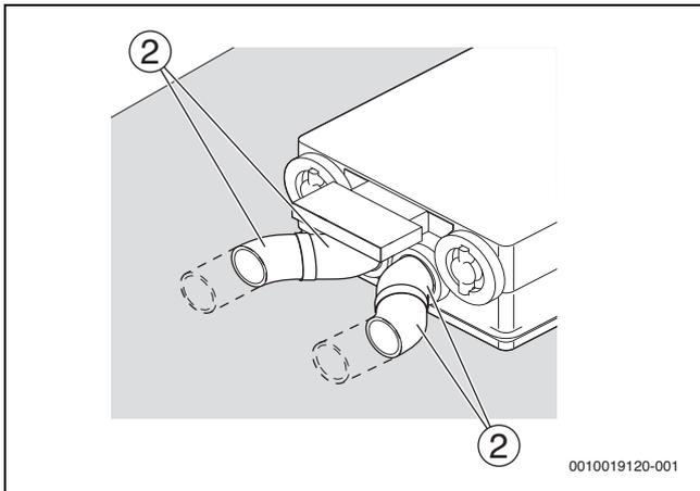
Bild 46 Anschlussdetails zu Bild 43: Rohrleitung Zu-/Abluftleitung
