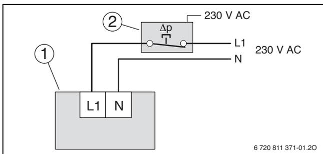
Bild 54 Anschluss Differenzdruckwächter in elektrischer Leitung
