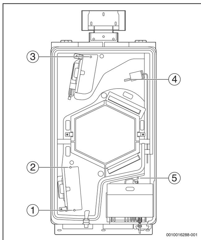
Bild 6 Position der Fühler
