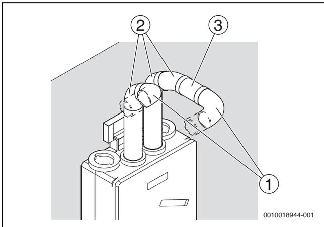
Bild 45 Anschlussdetails zu Bild 40 bis 42: Rohrleitung Zu-/Abluftleitung
