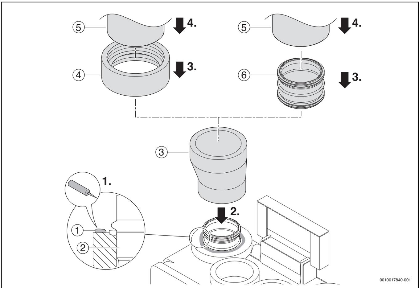
Bild 39 Adapter EPP 100/125 und EPP-Rohr montieren
