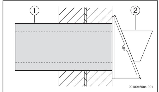
Bild 35 Rohrdämmung
