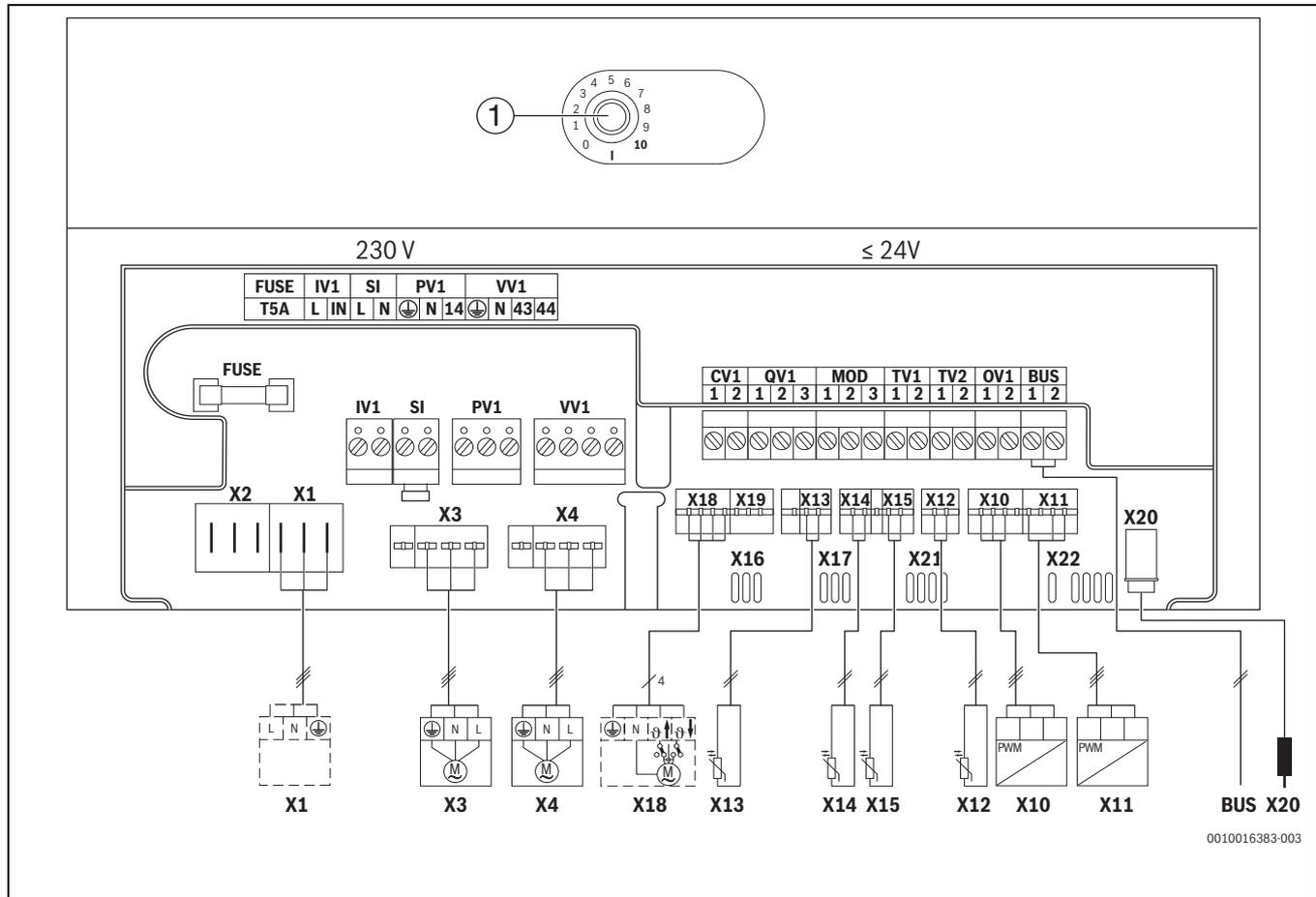
Bild 62 Werkseitige elektrische Anschlüsse auf der Leiterplatte
