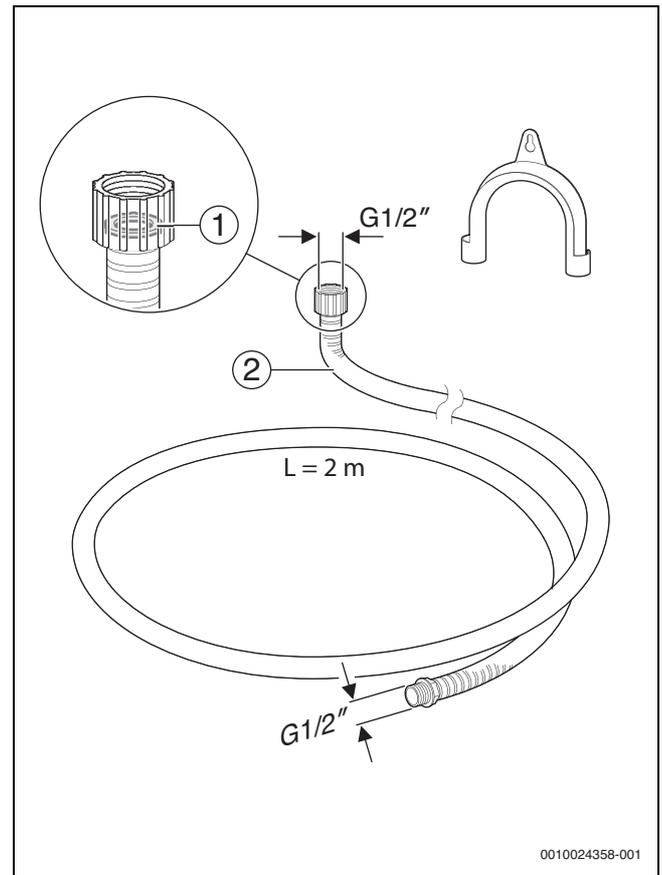
Bild 30 Schlauchsiphon-Anschluss-Set
