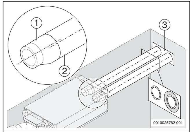
Bild 47 Anschlussdetails zu Bild 43: Rohrleitung Außen-/Fortluftleitung
