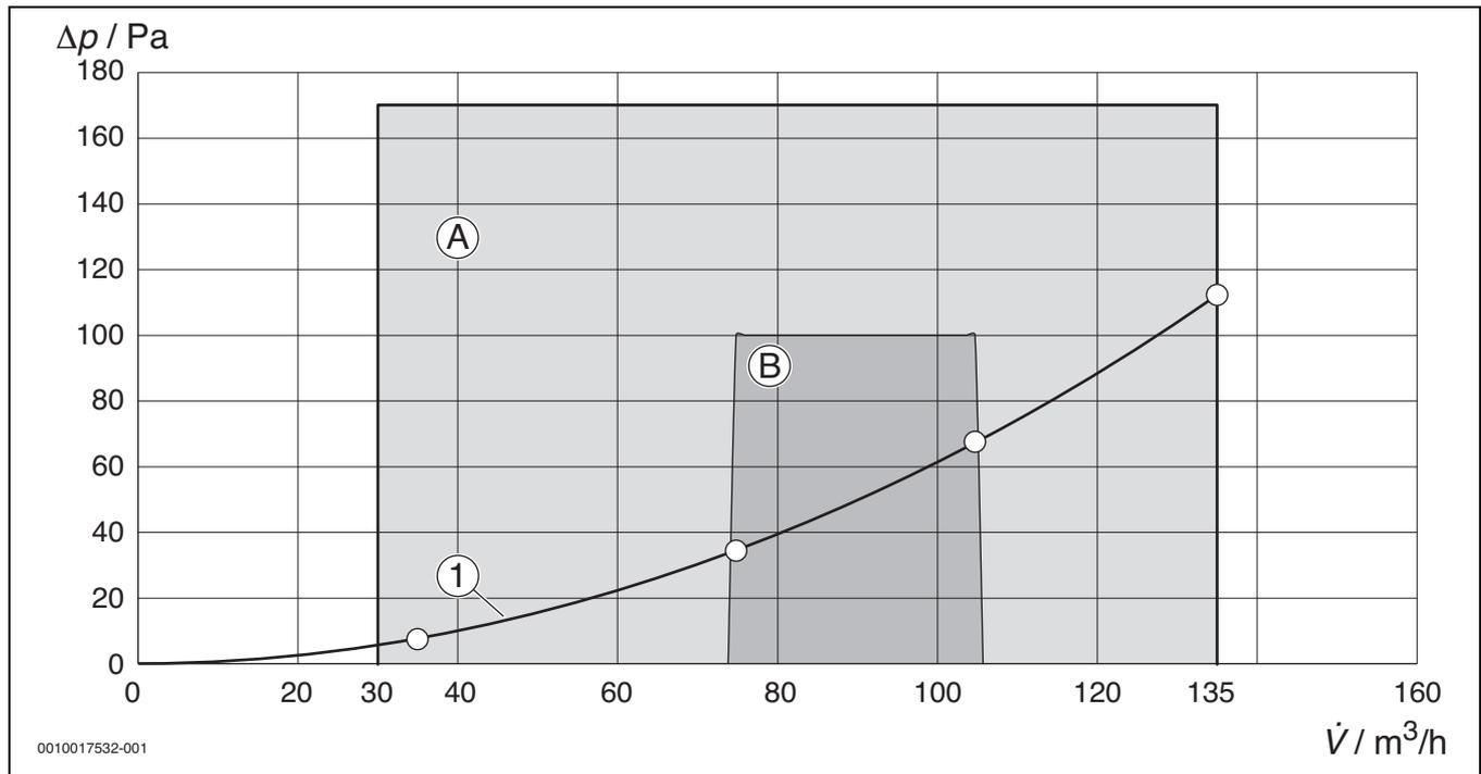
Bild 66 V4000CC 100 ...: Kennlinien Druckerhöhung/Volumenstrom (Lüftungsstufen nach DIN 1946-6)
