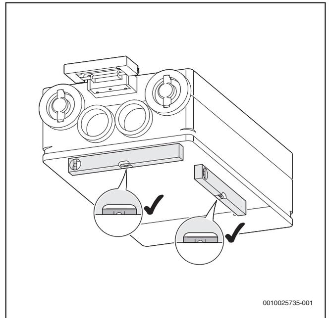
Bild 19 Einbaulage prüfen
