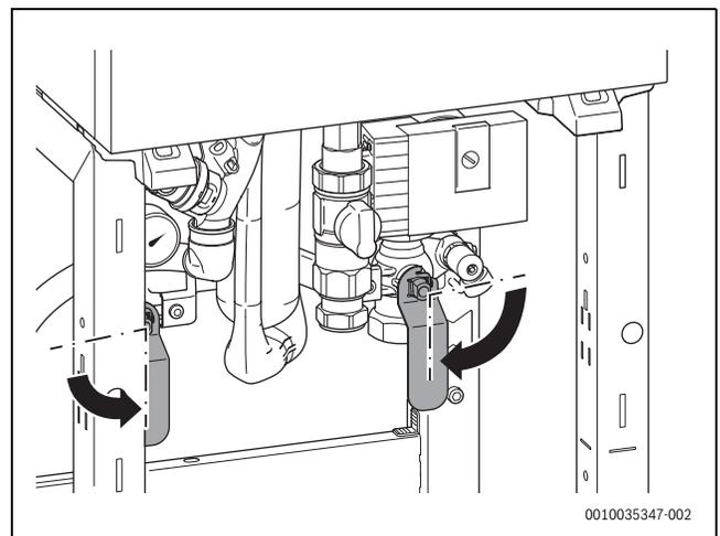
Bild 4 Öffnen der Serviceabsperrentile
