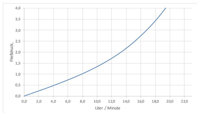
Der Maximaldruck an den Deckeneinbau-Brausen darf 3,5 bar nicht überschreiten.
