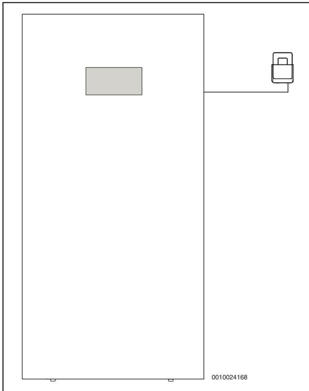
Bild 25 Anbringen des Halters an der Wand
