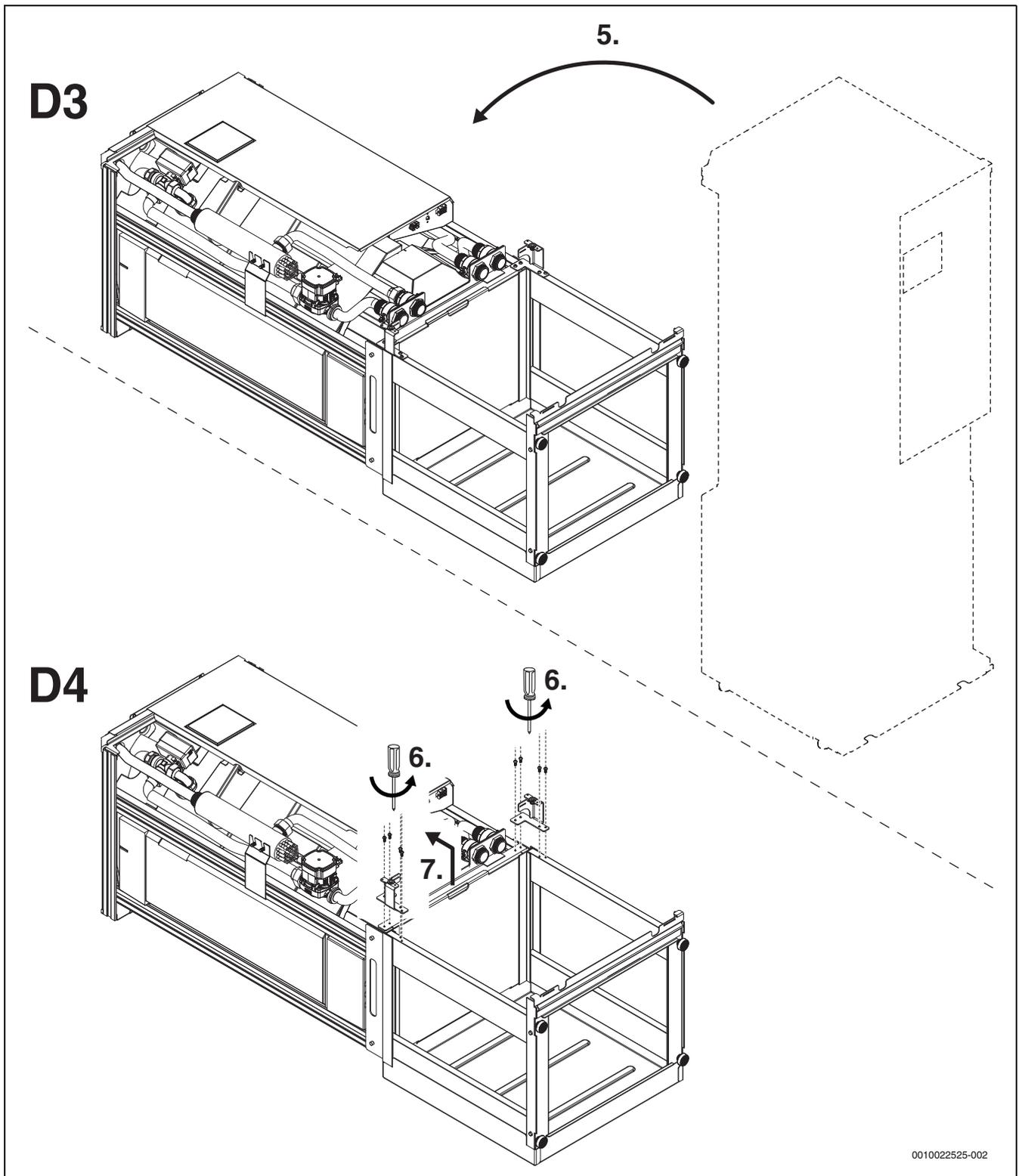
Bild 12 Zerlegen der Wärmepumpe
