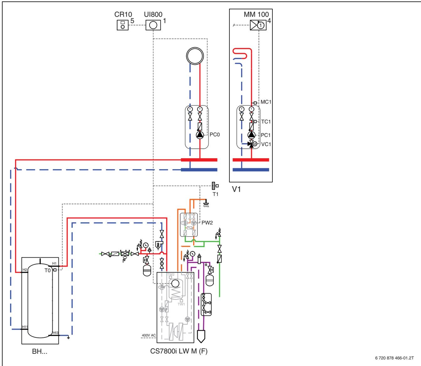
Bild 45 Parallele Pufferspeicher
