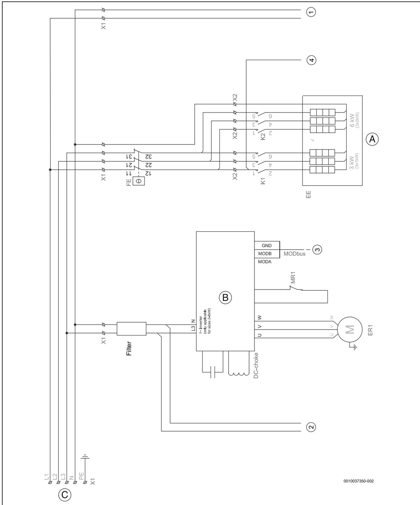
Bild 50 Schaltplan Hauptkreis, 6-8 kW
