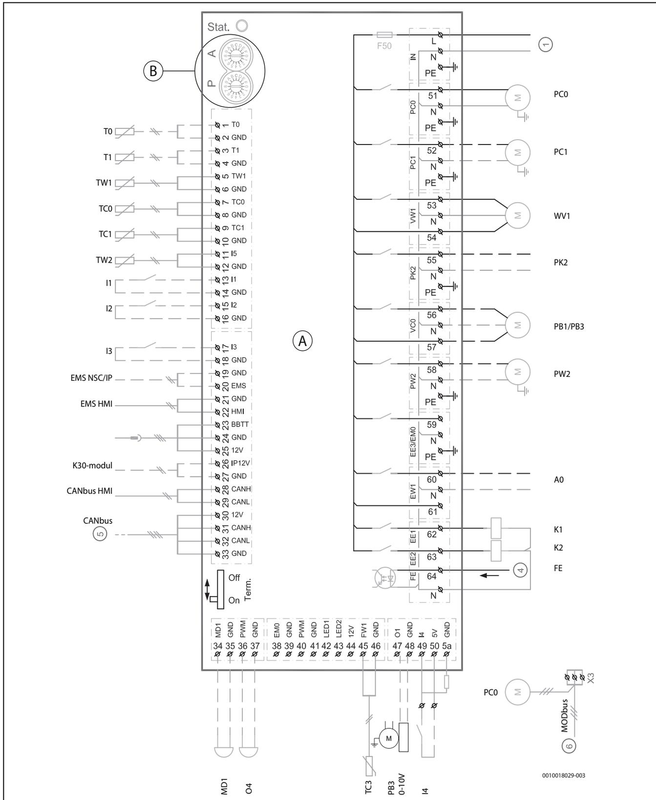
**Bild 52** Schaltplan Installationsleiterplatte
