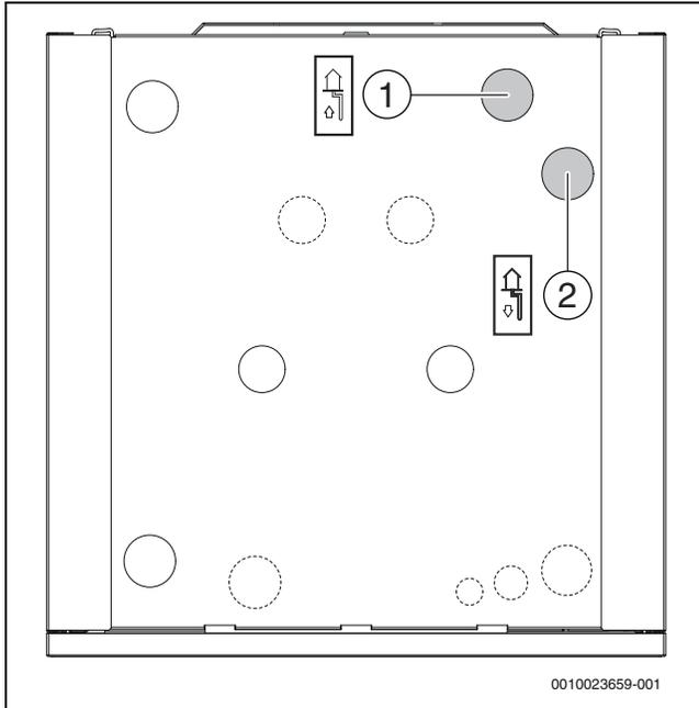
Bild 15 Anschlüsse der Wärmepumpe an das Solesystem
