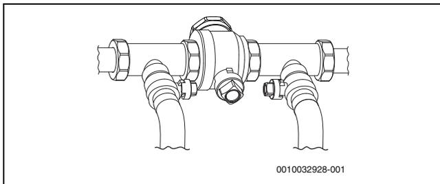
Bild 27 Befülleinrichtung
