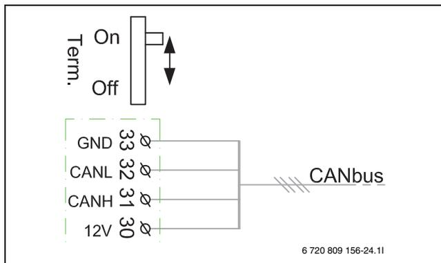
Bild 18 CAN-BUS-Terminierung
