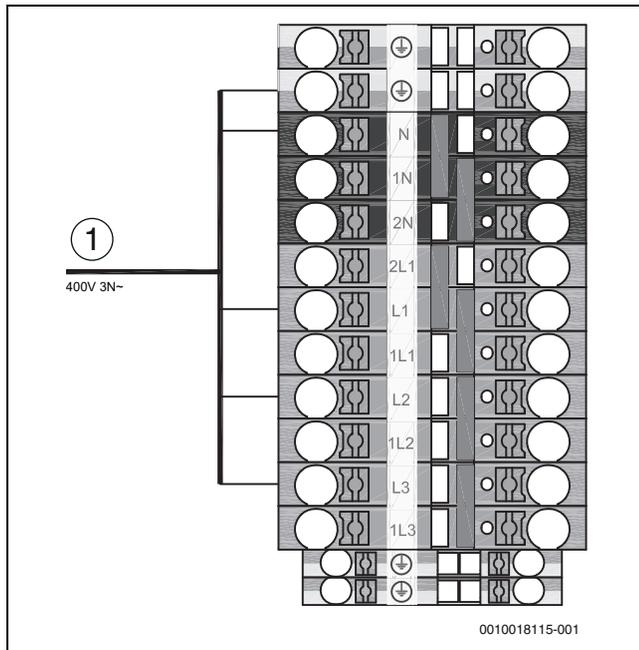
Bild 47 Spannungsversorgung im Auslieferungszustand (6 kW, 8 kW, 12 kW, 16 kW)
