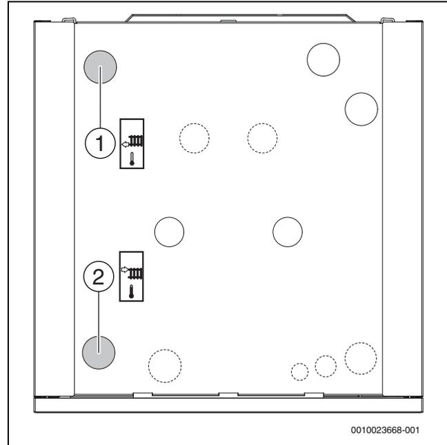
Bild 16 Anschlüsse der Wärmepumpe an die Heizungsanlage
