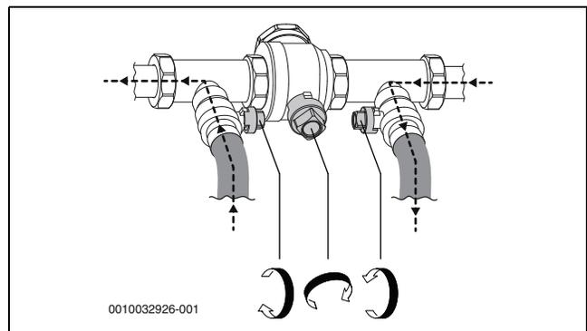
Bild 29 Befülleinrichtung in Befüllposition
