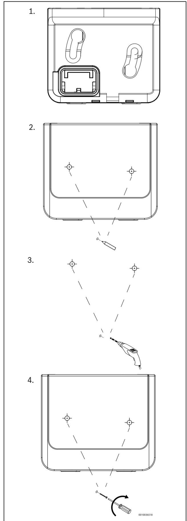
Bild 26 Montage des Halters an der Wand
