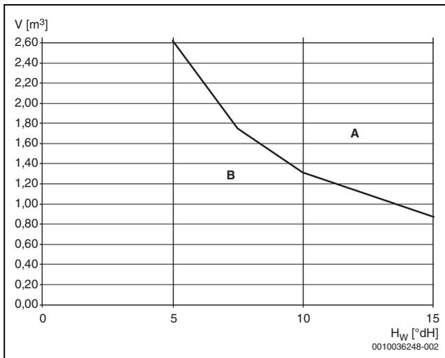
Bild 1 Grenzwerte für die Wasseraufbereitung bei Wärmepumpenanlagen
