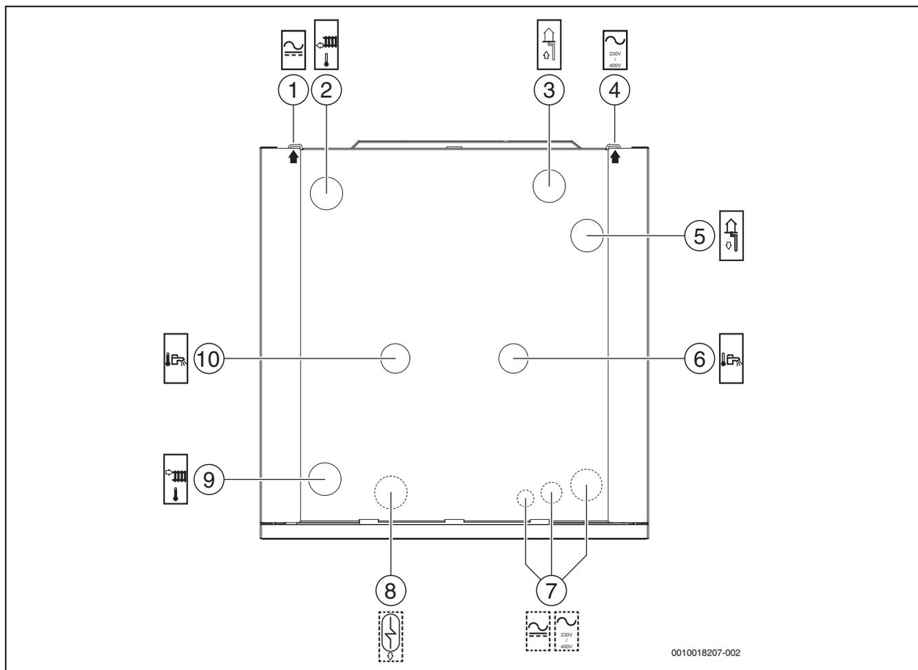
Bild 6 Anschlüsse der Wärmepumpe, Ansicht von oben
