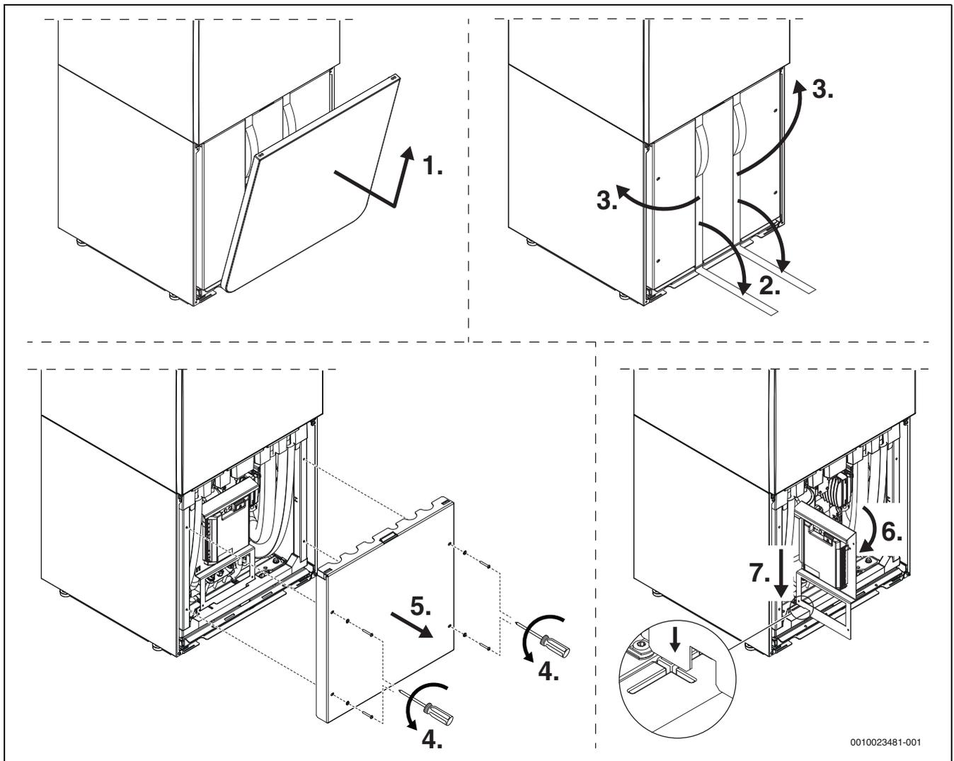
Bild 37 Zugänglichkeit des Kältekreis für einfache Wartungsarbeiten
