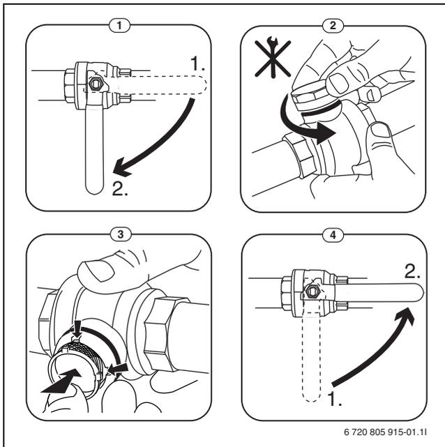
Bild 40 Siebreinigung
