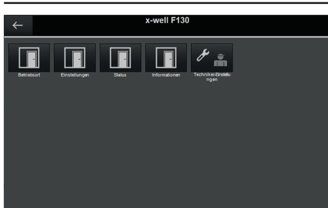
Im Menü **Betriebsart** kann beispielsweise die Lüftungsstufe angepasst oder das Gerät auf Standby geschaltet werden.
