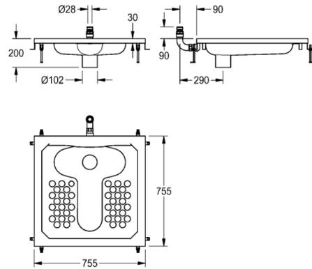
Hock-WC, aus Chromnickelstahl, Oberfläche seidenmatt, Materialstärke 1 mm, passend für Wandeinbau-Druckspüler DN 20, Wasserspülmenge 9 Liter, mit umlaufender Abkantung (22 mm) und umlaufenden Spülrand. Anschluss hinten senkrecht mit Verschraubung Durchmesser 28 mm, Abgang innen senkrecht DN 100, inklusive Befestigungsmaterial und Höhennivellierung.
