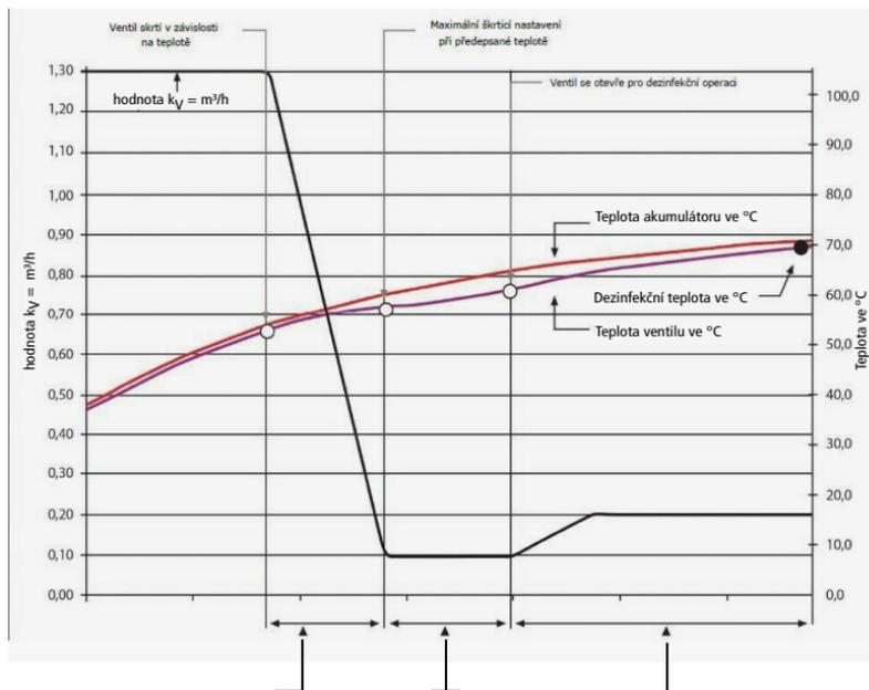
Mezi 53 °C a nastavenou předepsanou hodnotou 58 °C se škrtění nastavuje v závislosti na teplotě.
