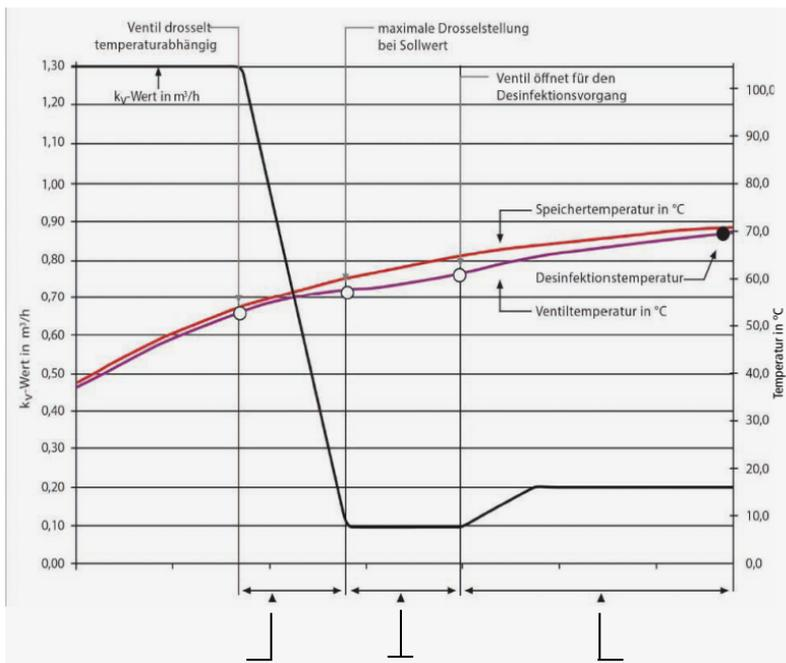
Zwischen 53 °C und eingestelltem Sollwert 58 °C werden Drosselstellungen temperaturabhängig eingestellt.
