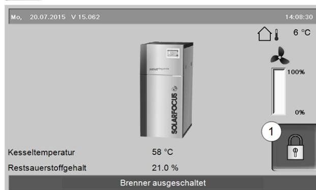
Die Funktion dient zum Schutz vor unbefugter Änderung der Regelungsparameter. Bei aktiver Benutzersperre werden die Parameter der einzelnen Masken angezeigt, diese können aber nicht geändert werden. Die aktive Benutzersperre wird in den Masken durch ein Vorhängeschloss Symbol **1** signalisiert.
