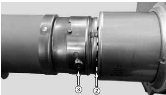
Abb. 4: Einstellung Rezirkulationsmaß R ② (Abbildung beispielhaft)
