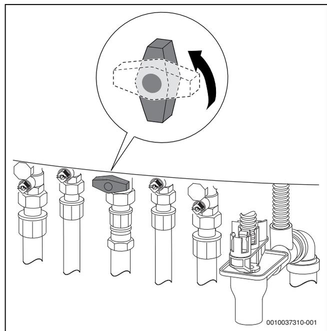
Bild 6 Gashahn öffnen (vertikal)
