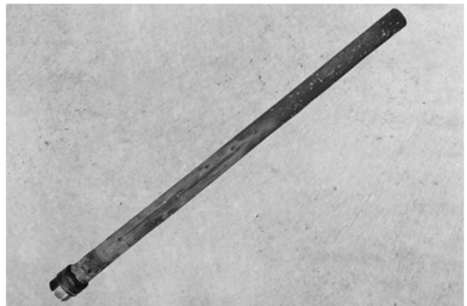
Abb. 87: Magnesium-Schutzanode, Länge 480 mm, Ø 26 mm
