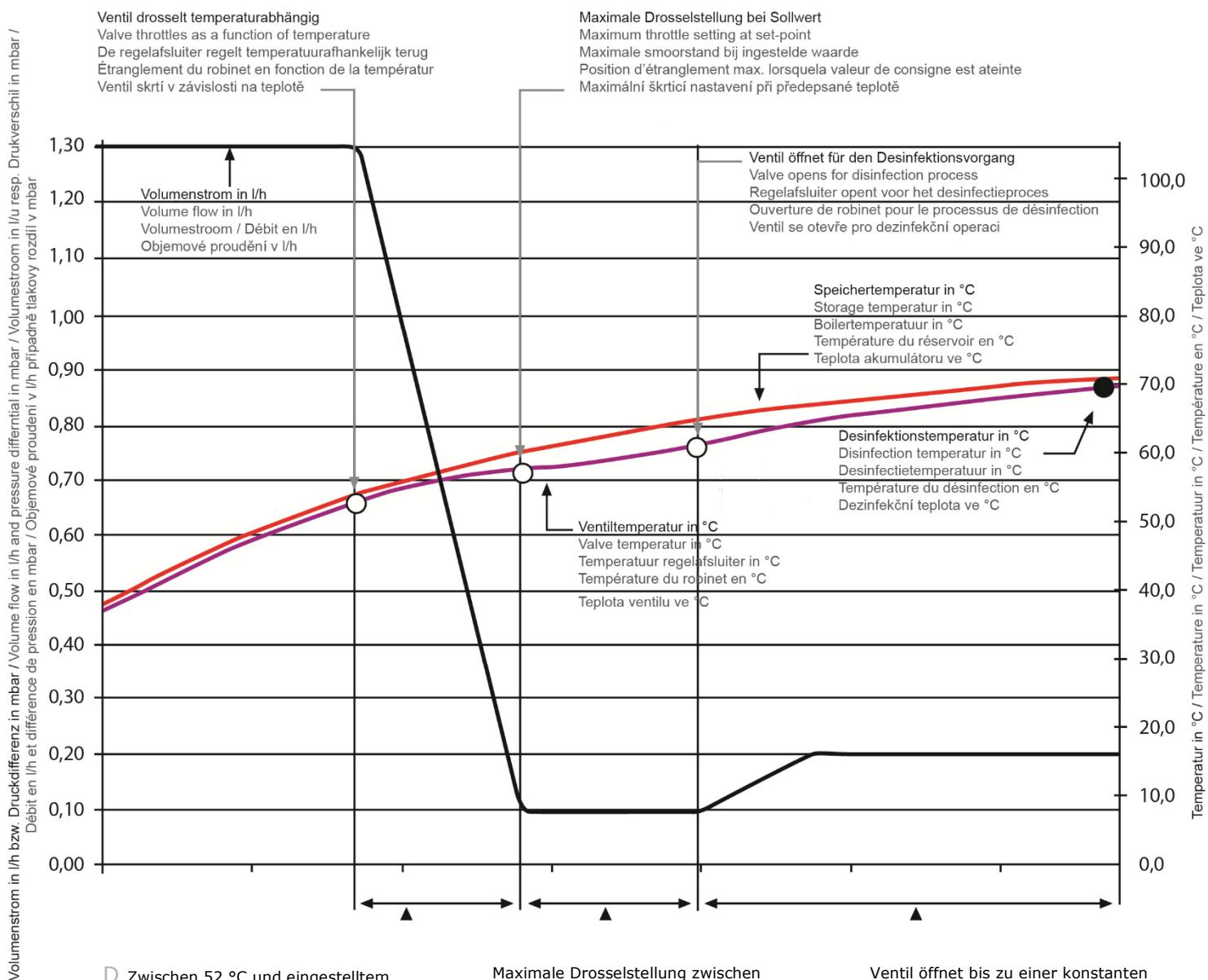
D Zwischen 52 °C und eingestelltem Sollwert werden Drosselstellungen temperaturabhängig eingestellt.
