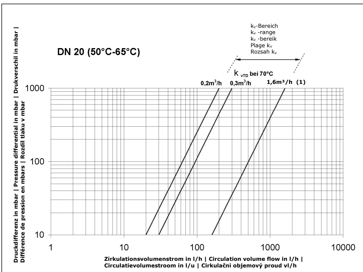
Durchflussdiagramm MULTI-THERM automatisches Zirkulations-Regulierventil
