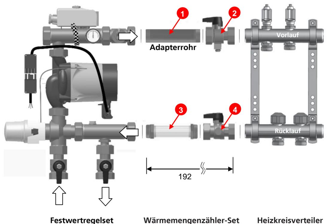
Hinweis: In Abhängigkeit der örtlichen Gegebenheiten ist eine zusätzliche bauseitige Befestigung (Schelle, etc.) der Pumpengruppe sinnvoll.
