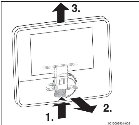
Bild 6 Bedieneinheit abnehmen
