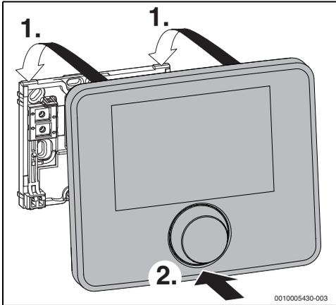
Bild 5 Bedieneinheit einhängen
