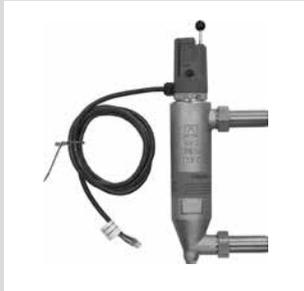
Bei Absinken des Wasserstandes im Wärmeerzeuger (z. B. Leck) senkt sich der Schwimmer der Wassermangelsicherung. Der Schwimmer ist über ein Gestänge mit einem Schalter verbunden, der die Feuerung abschaltet und verriegelt. Die Wassermangelsicherung verhindert, dass der Wärmeerzeuger ausglüht und zerstört wird. Eine regelmäßige Funktionsprüfung erfolgt durch Drücken der Prüftaste bis Anschlag. Die Wassermangelsicherung muss dann verriegeln. Anschließend Prüfstift hochziehen und entriegeln.
