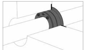
Curaflex® B, D, E, F: Der Großring muss an der Wand anliegen. Curaflex® D und F sind „druckseitig“ zu montieren.
