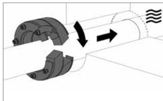
Schnellverschluss öffnen, Dichtungseinsatz um die Leitung herumlegen und mit dem Schnellverschluss verschließen. Weitere Montage wie unter „Position-Standard“ beschrieben.
