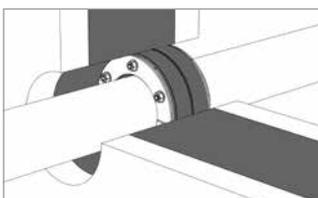
Dichtungseinsatz in der Dichtebene der Wand positionieren.
