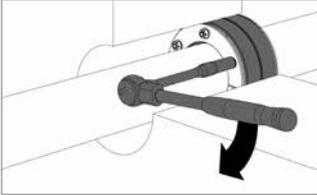
Zur Endmontage des Dichtungseinsatzes **die Muttern über Kreuz wechselweise** jeweils einige Umdrehungen anziehen, höchstens bis zum Erreichen des angegebenen Drehmomentes (siehe Tabelle Seite 4).
