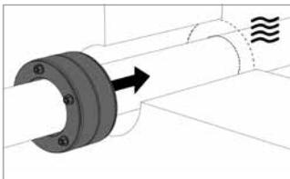
Bei WU-Betonkernbohrungen muss der Dichtungseinsatz möglichst weit auf der „wasserseite“ montiert werden.
