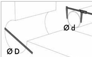
Durchmesser von Kernbohrung bzw. Futterrohr und der Medienleitung bestimmen und mit den Angaben auf dem Karton abgleichen.
