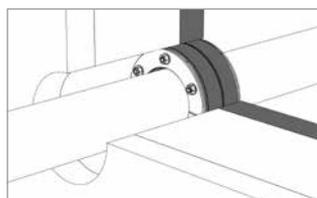
Dichtungseinsatz in der Dichtebene der Wand positionieren.
