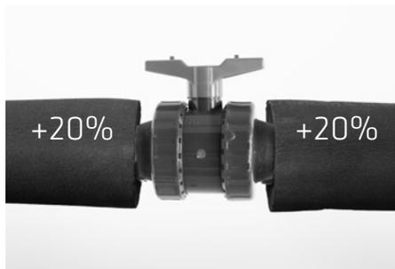
Etwa 10 cm von Armatur entfernt ggf. eine Schottverklebung anbringen. Zur Rohrdämmung ca. 20% in der Länge hinzugeben.
