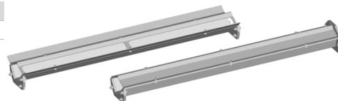
**Achtung !** Die einzelnen Kanalteile in korrekter Reihenfolge → Tabelle 4 zusammenbauen; andernfalls Gefahr von Verstopfung (wegen unterschiedlicher Steigung des Schneckenblattes; = progressive Schnecke).
