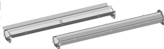
**Achtung !** Die einzelnen Kanalteile in korrekter Reihenfolge → Tabelle 2 zusammenbauen; andernfalls Gefahr von Verstopfung (wegen unterschiedlicher Steigung des Schneckenblattes; = progressive Schnecke).
