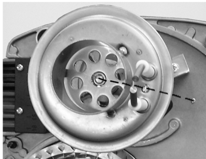
Abb. 25: Mischsystempositionierung und Ausrichtung Zündelektrode
