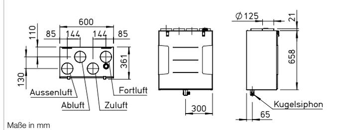
**Kompaktgeräte mit Wärmerückgewinnung für die zentrale Be- und Entlüftung von Wohnhäusern und Etagenwohnungen. Perfekt vorbereitet für moderne Kommunikation und Bedienung mit der neuen Helios easyControls 3.0 Steuerung inkl. integrierter Netzwerkanbindung. Ausgestattet mit EC-Ventilatoren für geringen Energieverbrauch und hocheffizientem Kunststoff- oder wahlweise Enthalpie-Wärmetauscher für zusätzliche Feuchterückgewinnung.**
