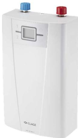
Durchlauferhitzermodul zur elektronischen Nachheizung des Trinkwassers, das als Erweiterungsmodul optional zur Wohnungsstation Regudis W-HTE installiert werden kann, um die Trinkwarmwasser-Temperatur auf einen höheren Wert, als den durch die Heizwasser-Temperatur erreichbaren, aufzuheizen.
